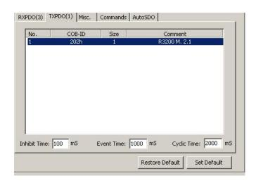
这样作为主站 PLC\_CAN 模块的 TXPDO1 与作为从站 KT270 驱动器的 RXPDO1 就做好了连接关系。实际上驱动器的 CONTROLWORD 与永宏 PLC 的 R3200 就做了映射关系。
