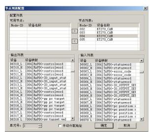
当添加完成后,点击 NODE-ID=4 的节点后,在下方会显示站号 4 的 PDO 映射表。 我们将要用到 IO INPUT SET 和 IO OUTPUT SET。
