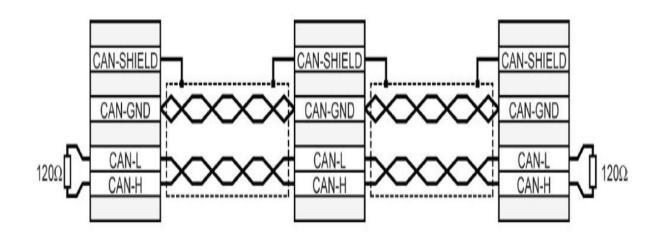
总线电缆请选用有两对双绞线的带屏蔽层电缆:一对双绞线分别接CAN-L 和CAN-H。
